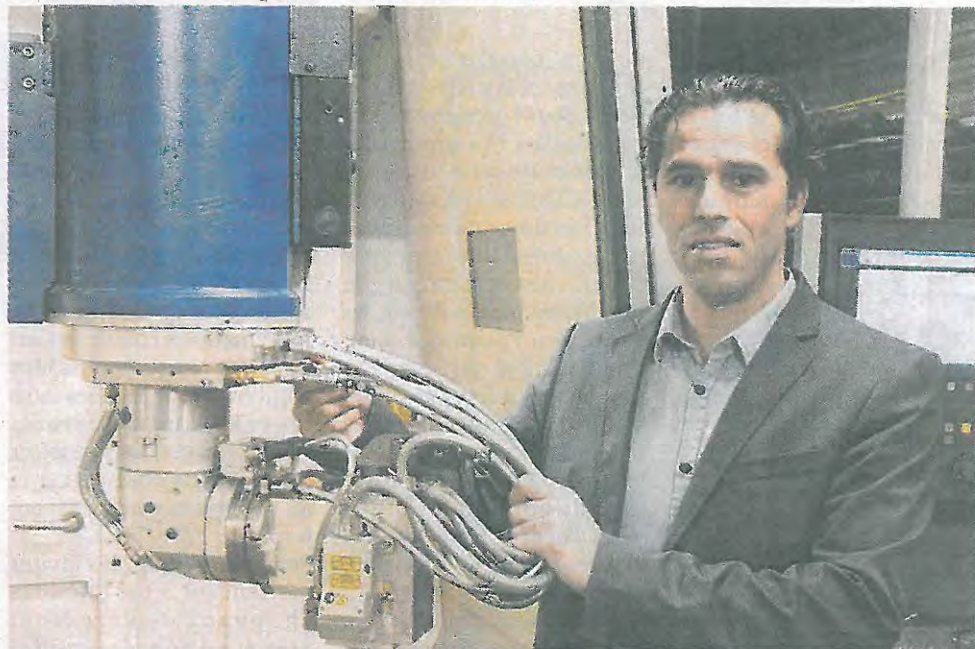
■ Kamel Semaoune présente la tête laser qui permet à la fois la soudure, la découpe et le rechargement. Photo Alain Laffay
